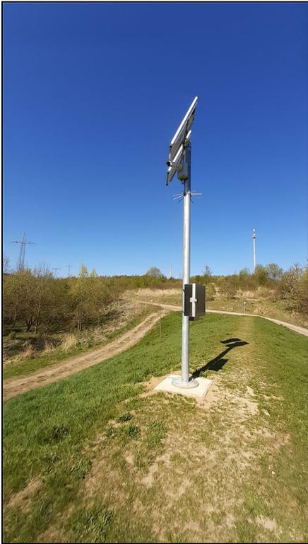
Abb. 1: Solarpaneel, Kamera und Datenlogger von BÜW018 im HRB Kaitzbach 3, 22.04.2020
